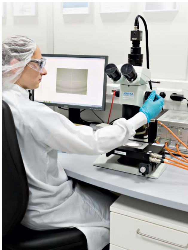
Bild 2: Die Sauberkeitsanalyse wird bei Arnold im modernen Cleancon ® -Labor nach VDA19.1 gemacht. Hier steht ein umfangreiches Prüfequipment zur Verfügung. (Bild: ARNOLD UMFORMTECHNIK)
