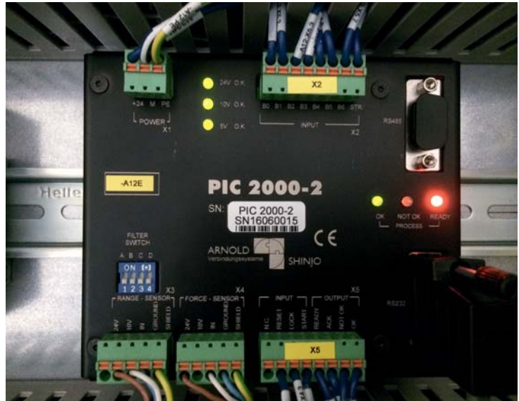
Die Auswerteeinheit, an der auch die Sensoren für Weg und Kraft angeschlossen werden, ist zur Hutschienenmontage im Schaltschrank vorgesehen. Bild: ARNOLD UMFORMTECHNIK
